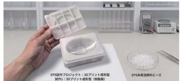
【図 6：3D プリンタによるプロトタイピングの様子】
