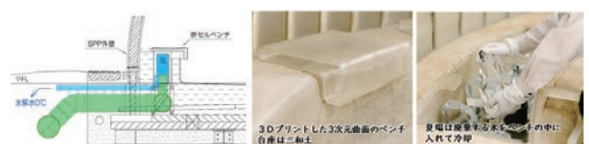
「廃氷」とクールチューブによる冷却の仕組み
