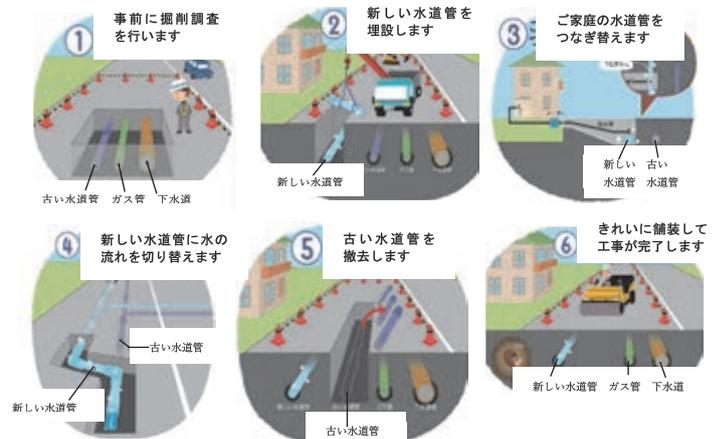
図6 更新工事の流れ (仙台市水道局ホームページより引用)
