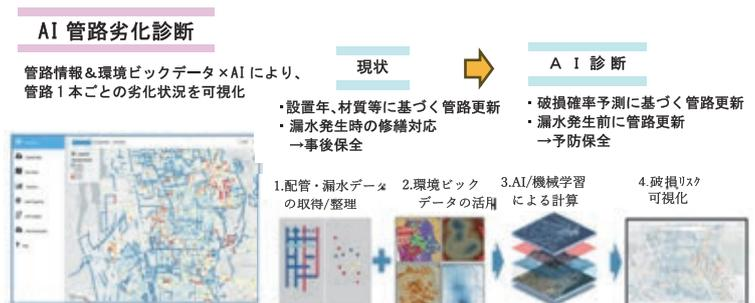
図4 AIを活用した老朽度評価モデル<sup>8)</sup>
