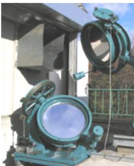
太陽分光望遠鏡 ・和尚が磨いた鏡 日本最大の70cm シーロスタット (太陽追尾機構) ・焦点距離20m！ 中はどうなってる？
