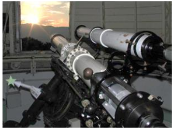
18 cm 屈折望遠鏡 日本最古の現役望遠鏡 116歳！
