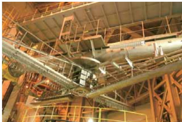
可動ドーム下にある主鏡のメッキ・洗浄装置
