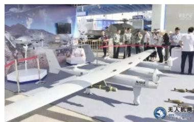
左右にプロペラとバッテリーを収納する双胴型の V700 機体 SMD 社 HP より
